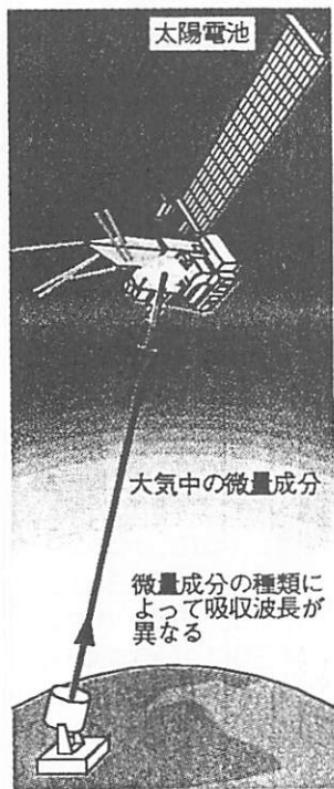
「ADEOS」が地上局上空を通過する時にレーザー光を発信、鏡で反射させ測定する
